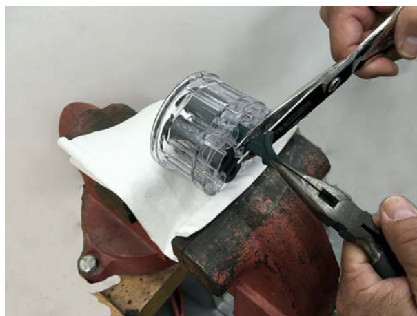
Obrázek 26 Demontáž škrticího ventilu
